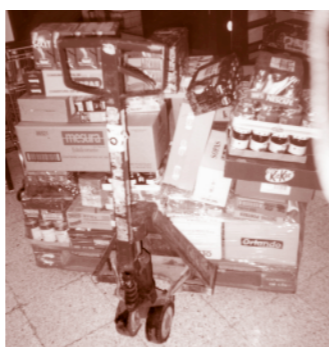
Transpaleta carregada de productes.
