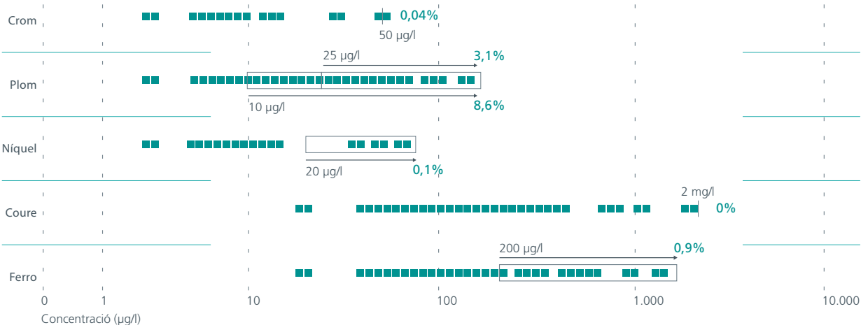
Figura 4. Concentració dels metalls crom, plom, níquel, coure i ferro a les aixetes dels ciutadans i percentatge de mostres que superen el límit paramètric establert pel RD 140/2003. Barcelona, 2004-2011.
